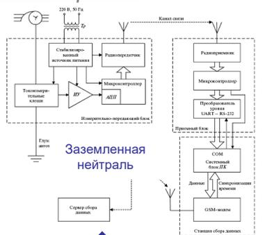
Рис. 1. Структурная схема системы регистрации градиентного тока. АЦП – аналого-цифровой преобразователь, АПУ – автономный источник питания, ДТ – датчик тока, ПЭ – персональный компьютер, GSM – система сотовой связи.
